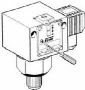
**Abb. 10. Mechanische Verriegelung**
