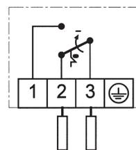
Umschaltung und Verriegelung bei fallendem Druck.
