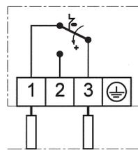
Umschaltung und Verriegelung bei steigendem Druck.
